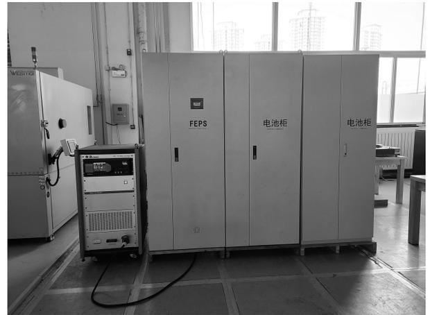
电压暂降、短时中断和电压变化的抗扰度
