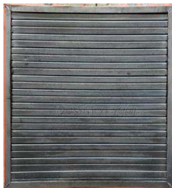
照片2 耐高温性能试验后试件情况
