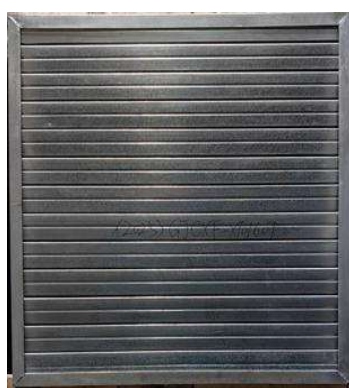
照片1 耐高温性能试验前试件情况
