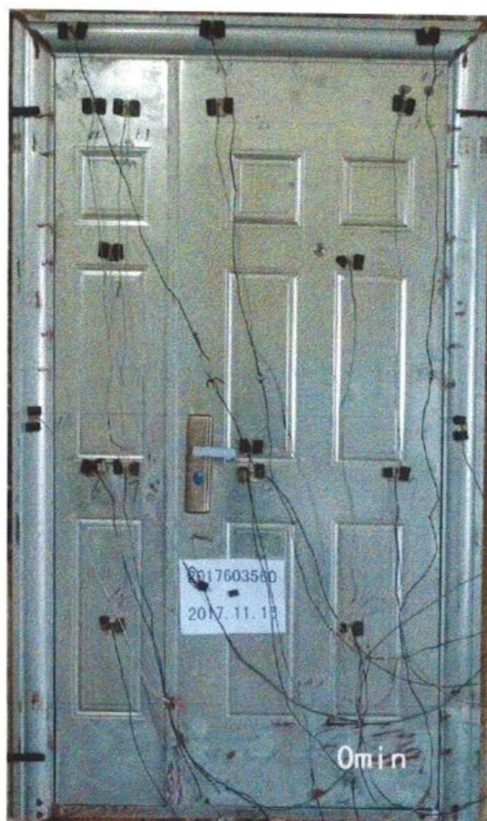
照片 1 耐火试验前试件情况
